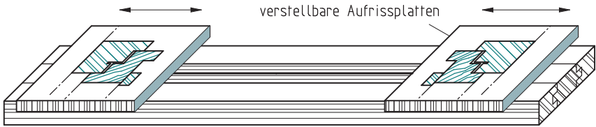
Bild 1.2-6 Aufrisslehre mit verstellbaren Aufrissplatten
